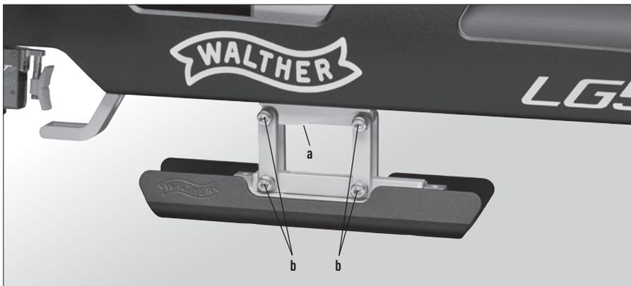
Die Vorderschafterhöhung für das Stehendsschießen lässt sich in Längsrichtung, in der Breite und in der Höhe einstellen. Weiterhin ist ein Verschwenken um die Laufachse möglich. Zum **Abbau oder Verschieben der Vorderschafterhöhung** in Längsrichtung die **Schraube (a) lösen**; dadurch wird die Klemmung in der Halter-schiene aufgehoben.
