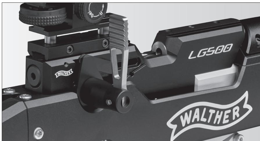
Inserire il diavolo nella cavità di caricamento come rappresentato in figura e chiudere la leva d'armamento. Il segno rosso del perno caricatore vi indica lo stato di carico dell'arma. Azionando il grilletto, il percussore precedentemente armato viene rilasciato e la valvola della camera di scoppio si apre, per cui l'aria precompressa spingerà il diavolo fuori dalla canna.
