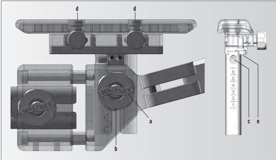
Le **déplacement latéral de la joue** est réalisé tout aussi confortablement en butée, en dévissant les deux vis de blocage (d). La joue peut être déplacée en direction du visage ou à l'opposé avec la molette de réglage. Resserrer les vis de blocage (d) après ajustement.
