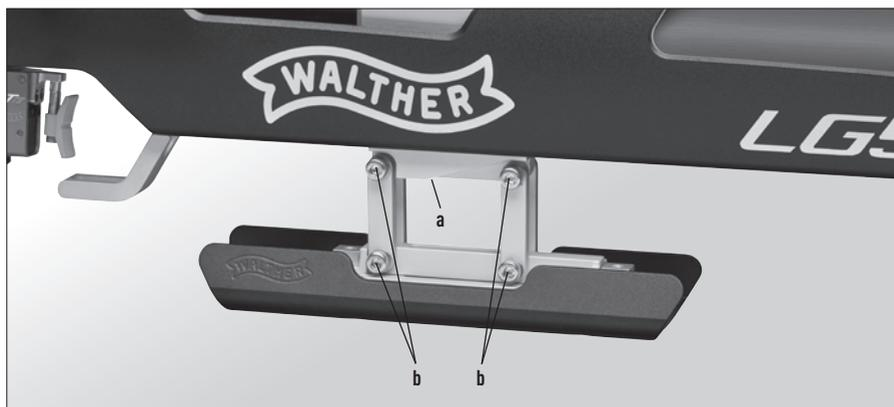
L'elevazione del fusto per il tiro in piedi può essere operata in senso longitudinale, in larghezza e in altezza. Inoltre è possibile l'orientamento del fusto intorno all'asse della canna. **Per ridurre o spostare** l'elevazione del fusto **in senso longitudinale**, allentare le viti (a) per eliminare il serraggio del fusto nella rotaia d'arresto.
