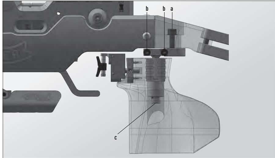
Per la **regolazione longitudinale e laterale**, allentare la vite (a) e realizzare la posizione desiderata. Lo spostamento laterale avviene mediante la rotazione del braccio di estensione, successivamente la posizione voluta deve essere fissata con la vite (a).
