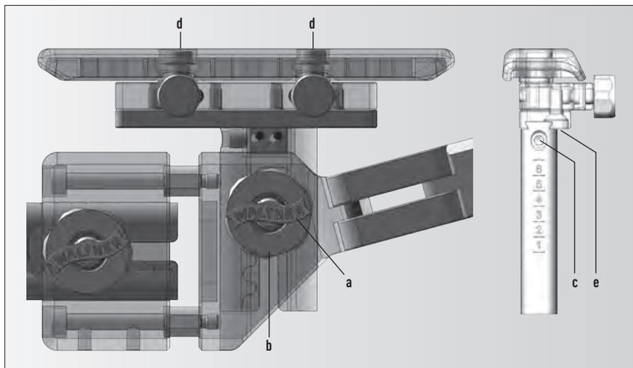
Lo **spostamento laterale** della placca poggiaguancia è realizzato in modo altrettanto comodo, in posizione di tiro, allentando le due viti d'arresto (d). La placca poggiaguancia può essere avvicinata al viso o allontanata da esso tramite la rotazione del collare. Ad aggiustaggio avvenuto, riserrare le viti d'arresto (d).
