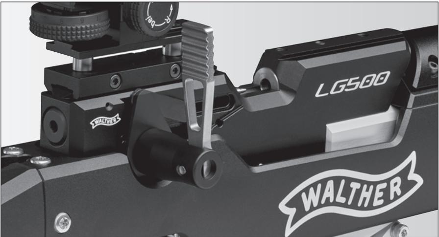
Das Diabolo in die Lademulde legen und den Ladehebel schließen. Den Ladezustand Ihrer Waffe erkennen Sie an der nun roten Kennzeichnung des Ladestößels. Durch Betätigen des Abzuges wird das vorgespannte Schlagstück freigegeben und öffnet das Ventil der Schusskammer, wodurch die vorkomprimierte Luft das Diabolo aus dem Lauf befördert.
