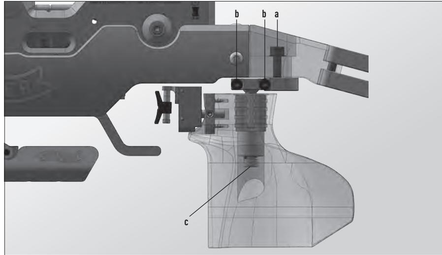
Para regular la longitud y realizar el desplazamiento lateral, afloje el tornillo (a) y ajuste a la longitud y posición lateral deseada. El desplazamiento lateral se realiza girando el brazo. Fije este ajuste con el tornillo (a).
