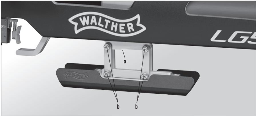
L'élévation (bossage) du fût pour le tir debout peut être réglée dans le sens longitudinal et en hauteur. En outre, un pivotement autour de l'axe du canon est également possible. Pour **démonter ou déplacer le bossage** du fût dans le sens longitudinal, dévisser **les vis (a)** afin de desserrer le rail de maintien.
