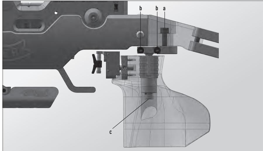
Zur **Längsverstellung und seitlichen Auslagerung** Schraube (a) lösen und in die gewünschte Längsstellung und die seitliche Auslagerung bringen. Die seitliche Auslagerung erfolgt über Drehung des Auslegers, mit Schraube (a) diese Einstellung fixieren.
