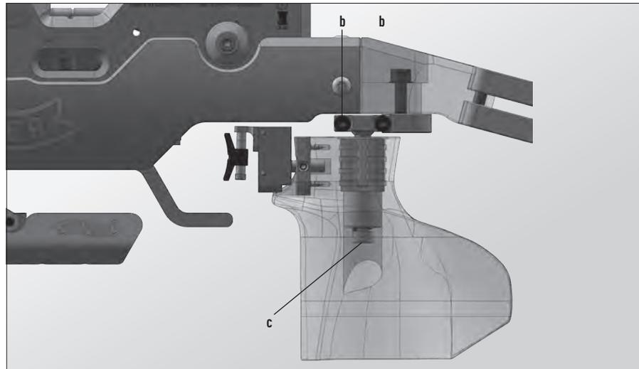
Pour un déplacement longitudinal ou latéral, devisser la vis (a) et mettre la poignée dans la position latérale et longitudinale souhaitée. Pour le déplacement latéral, tourner la béquille. Fixer ensuite le réglage à l'aide de la vis (a).
