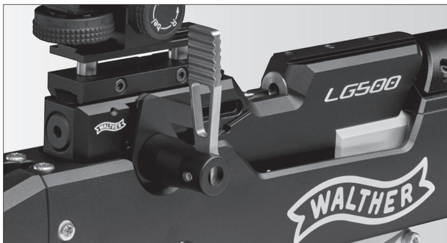
Poser le diablo dans la cavité du chargeur comme et refermer le levier de chargement. La marque rouge située sur le poussoir de chargement vous indique que l'arme est chargée. L'actionnement de la détente libère le support-percuteur préarmé et ouvre la soupape de la chambre de tir, ce qui entraîne l'expulsion du projectile hors du canon sous l'effet de l'air précomprimé.
