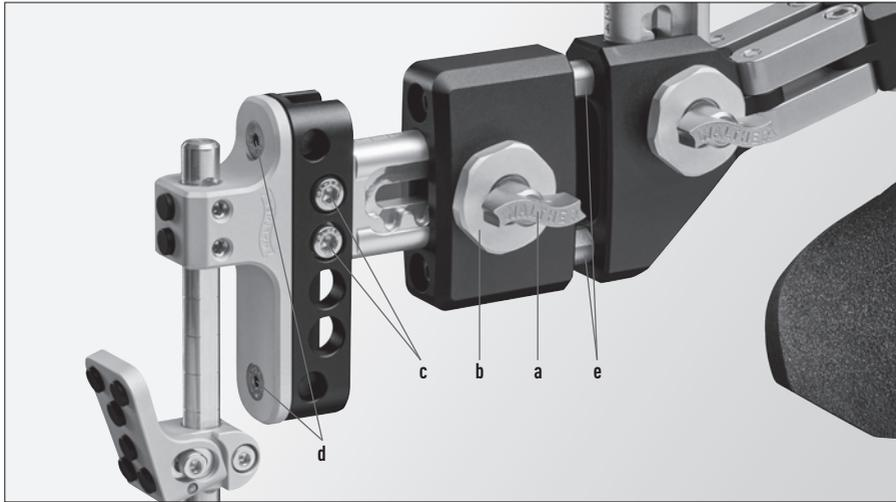
Pour modifier la longueur de la crosse, desserrer la **vis de blocage (a)** puis choisir la longueur désirée en tournant la **roulette moletée (b)**. Ensuite, bloquer à nouveau la roulette moletée (b) avec la vis de blocage (a). Si la crosse ne peut pas être suffisamment allongée, il est possible d'obtenir une longueur plus importante à l'aide de tiges plus longues (accessoires spéciaux). Une autre possibilité d'allonger la crosse consiste à insérer **des rallonges supplémentaires (e)**.
